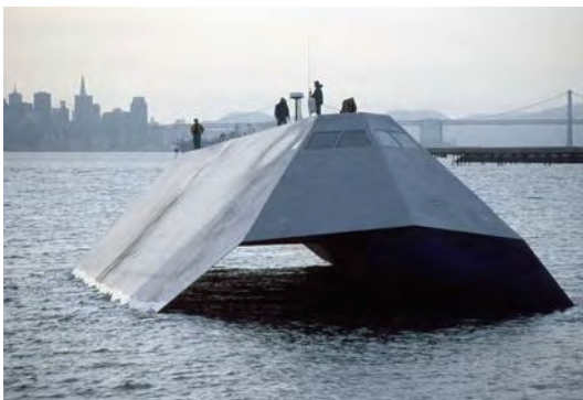
Le Sea Shadow (IX-529) est un navire furtif expérimental construit en 1982 et possédant une géométrie singulière, qui lui permettait d'être très peu détectable par les radars
