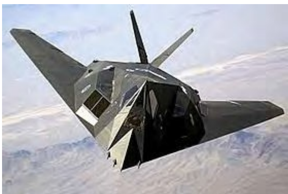
Le F-117 Nighthawk, un avion d'attaque au sol furtif conçu par l'armée américaine pour avoir la signature radar la plus faible possible. Il est constitué de surfaces planes disposées de façon à ne jamais être en même temps face à un radar.
